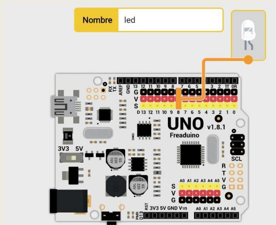
Vamos a realizar la programación. Ve a la pestaña **Software** y pincha sobre **Componentes**. Allí encontrarás el bloque *Encender/Apagar el LED nombre\_led*. Arrástralo dentro del bloque **loop**.
