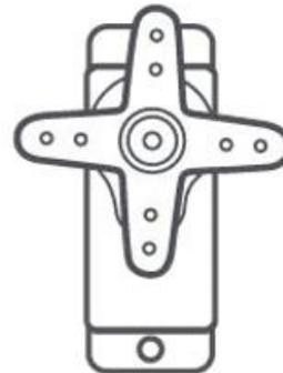
**Servo:** Transforma la corriente eléctrica en movimiento circular y puede detenerse en un ángulo concreto.
