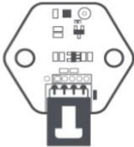
**Sensor de temperatura y humedad:** Es capaz de detectar la temperatura y humedad del ambiente.
