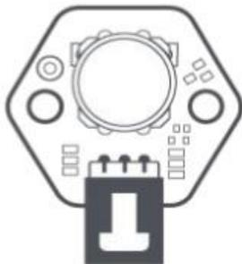
**Pulsador:** Botón que permite el paso de corriente eléctrica al pulsarlo y no la permite al soltarlo (cierra y abre el circuito).
