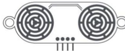
**Sensor de ultrasonidos:** Detecta la distancia a la que se encuentran los objetos emitiendo una onda ultrasónica y calculando el tiempo que tarda en regresar tras rebotar con algún objeto.
