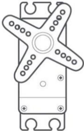
**Motor eléctrico o servo de rotación continua:** Transforma la corriente eléctrica en movimiento circular.
